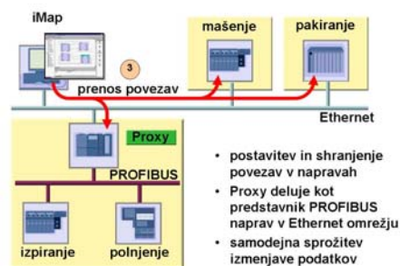
Slika 5: PROFInet CbA – prenos konfiguracije v sistem
