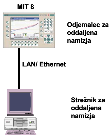
Slika 5: Primer uporabe MIT 8 kot odjemalca za oddaljena namizja
