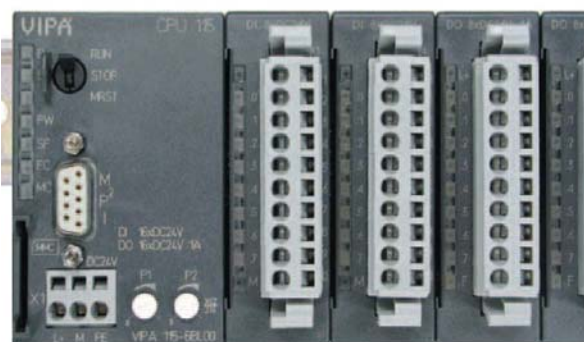
Slika 3: Centralna procesna enota z digitalnimi vhodi-izhodi
