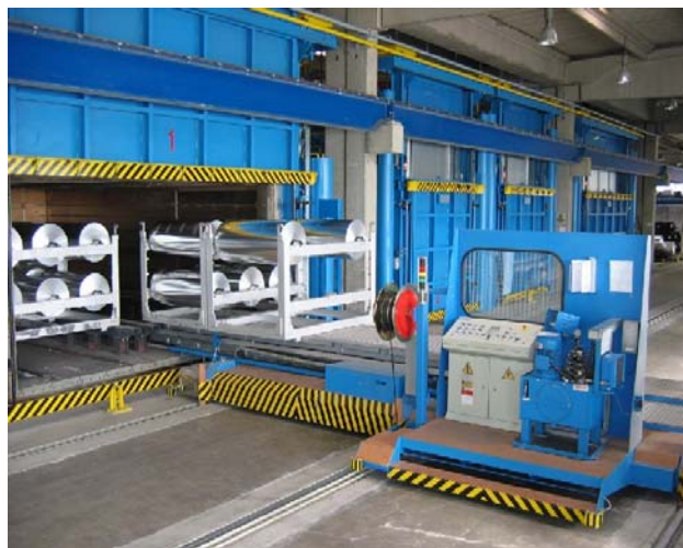
Slika 2: Transportni voz pri zalaganju žarilne peči
