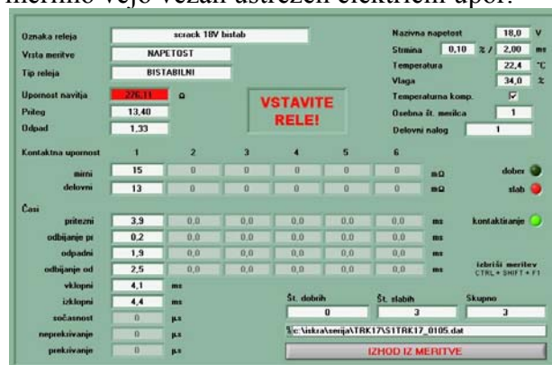
Slika 3: Zaslon avtomatske meritve merilnika električnih parametrov relejev
