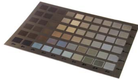
Slika 2: Barvni spekter pri graviranju titana
