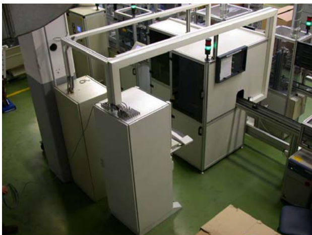
Slika 2: Diagnostični sistem za sesalne enote
