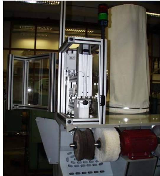
Slika 3. Polirni stroj z enoto za dodajanje polirnega voska
