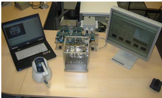
Slika 3.5: Aplikacija za krmiljenje nanorobotske celice s haptično napravo
