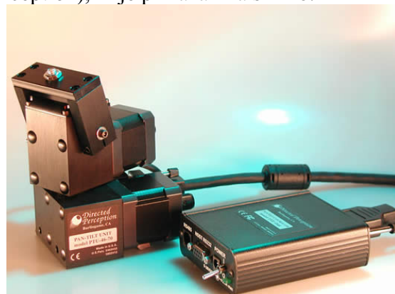
Slika 8: Enota za zasuk in naklon.
