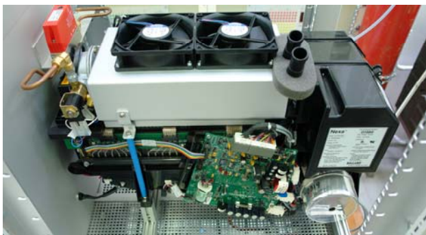
Slika 2: 1,2 kW agregat s PEM gorivnimi celicami Nexa proizvajalca Ballard.
