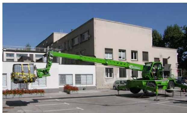
Slika 1: Hidravlično teleskopsko dvigalo Merlo ROTO MCSS 45.21 za manipulacijo bremena 2000 kg
