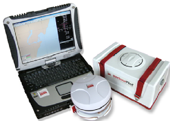
Slika 2: DGPS prenosna postaja [4]
