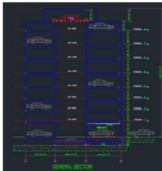
Slika 4: Načrt parkirne hiše (prečni prerez) [5]
