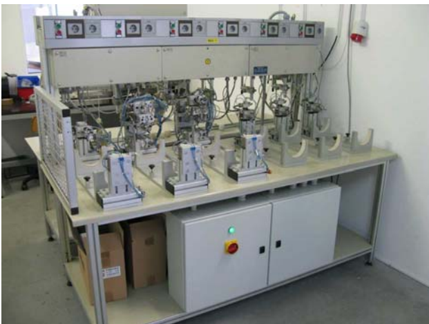
Slika 2: Testirna naprava s toasterji
