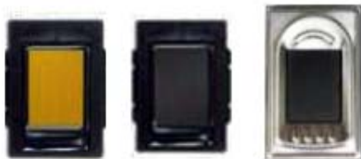
Slika 3. Senzor za statično zajemanje prstnega odtisa
