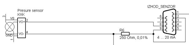
Slika 5: Vezava sensorja in tokovno napetostnega pretvornika
