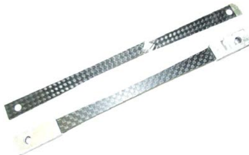
Slika 15: Vzorca karbonskih preizkušancev po in pred meritvijo natezne trdnosti
