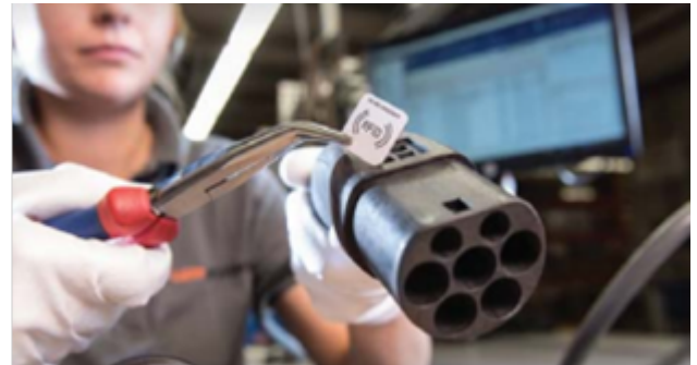
Slika 8: Kabel ölflex charge helix z integriranim RFID čipom.
