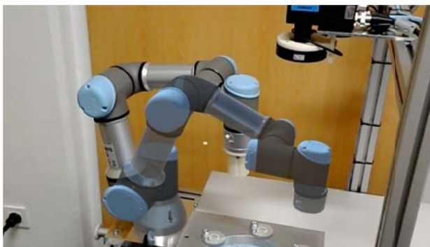
Slika 13: Holografski virtualni 3D model robota UR3e med izvajanjem simulacije prekriva realno okolje.
