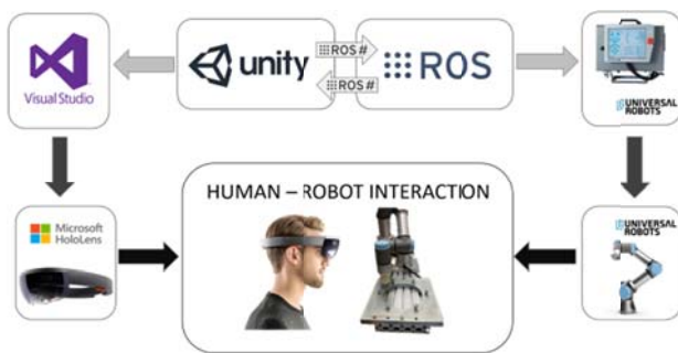
Slika 11: Komunikacijska arhitektura za obogateno resničnost s HoloLens očali.
