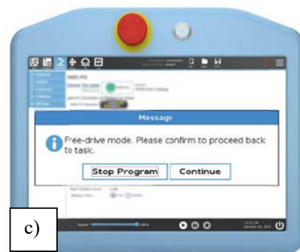
Slika 4: Detekcija dotika s preklpom v kinestetično vodenje; a) človek se dotakne robota b), robot zazna dotik in preklopi v kinestetično vodenje – človek lahko robota prosto premika, c) človek lahko sproži nadaljnje izvajanje robotskega programa.
